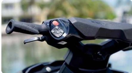
**iDF - Інтелектуальна система очищення водомета** (за додатковим замовленням) Інноваційна, перша в галузі система, яка дозволяє Вам звільнити Ваш водомет від водоростей і сміття простим натисканням на кнопку на кермі.
