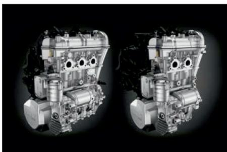
**ВАРІАНТИ ДВИГУНІВ НА ВИБІР:** 2-циліндровий Rotax 600 ACE має оптимальні робочі характеристики за доступною ціною, а 3-циліндровий Rotax 900 ACE є "золотим стандартом" потужності й неймовірних функціональних якостей!
