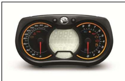
**Многофункциональная приборная панель с ЖК экраном**
