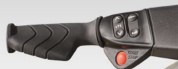
ВИСОКОЕФЕКТИВНА VTS™ (СИСТЕМА ДИФЕРЕНТОВКИ)
