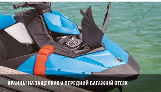
КРАНЦЫ НА ЗАЩЕЛКАХ И ПЕРЕДНИЙ БАГАЖНИЙ ОТСЕК
