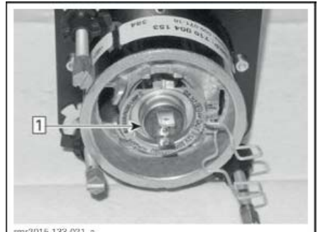
Шаг 1: Вытащите лампу из корпуса
