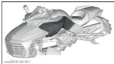
УСТАНОВКА ВЫСТУПОВ В ПРАВИЛЬНОЕ ПОСАДОЧНОЕ МЕСТО
