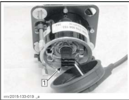
Шаг 1: Отсоедините разъем лампы
