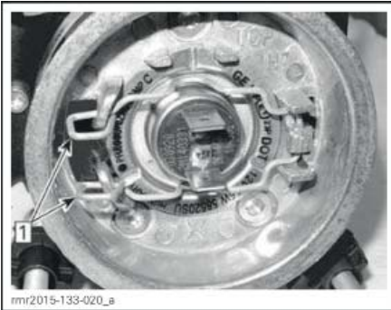
Шаг 1: Отсоедините пружинный хомут
