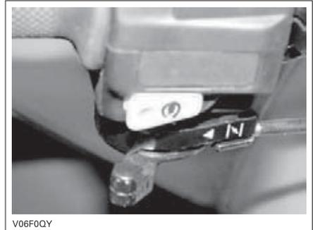
РЫЧАГ ОБОГАТИТЕЛЯ В КРАЙНЕМ РАБОЧЕМ ПОЛОЖЕНИИ
