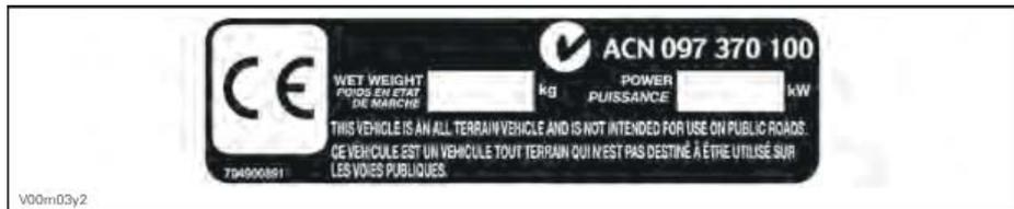
**РАСПОЛОЖЕНИЕ: НА ПРАВОМ НИЖНЕМ ЭЛЕМЕНТЕ РАМЫ СПЕРЕДИ – НЕ ИСПОЛЬЗУЙТЕ МОТОВЕЗДЕХОД НА ДОРОГАХ ОБЩЕГО ПОЛЬЗОВАНИЯ**
