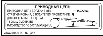
НАКЛЕЙКА РЕГУЛИРОВКИ ПРИВОДНОЙ ЦЕПИ
