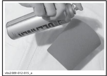
ТИПОВОЙ ВАРИАНТ - НАНЕСИТЕ ОЧИСТИТЕЛЬ НА ВНУТРЕННЮЮ И ВНЕШНЮЮ СТОРОНЫ ФИЛЬТРУЮЩЕГО ЭЛЕМЕНТА
