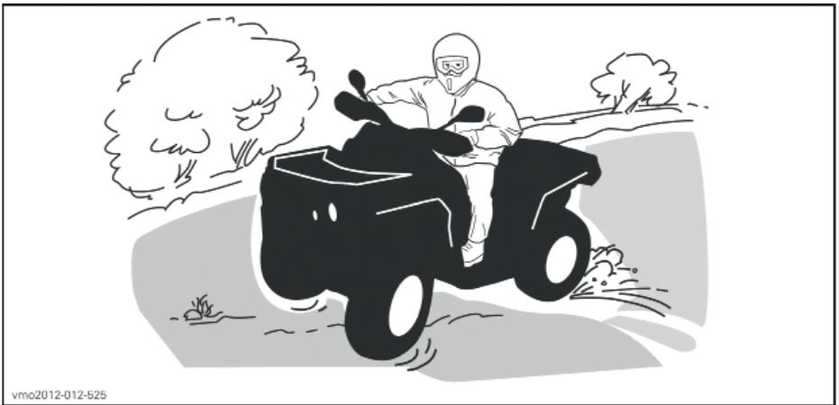
В случае, если вы попали в скольжение или занос, поворот руля в сторону заноса может помочь вам вернуть управление мотовездеходом. Ни в коем случае не блокируйте тормоза и колеса.
