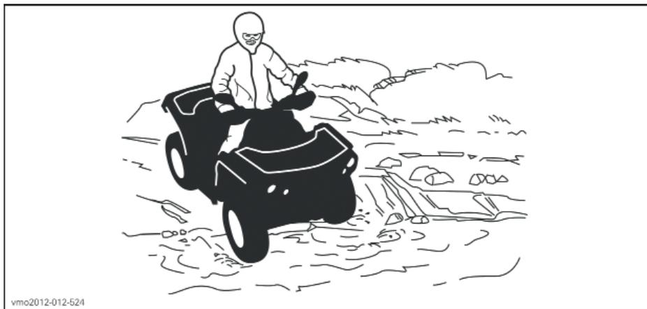
Мокрые тормоза негативно повлияют на возможности тормозной системы. После движения по воде, грязи или снегу обязательно несколько раз приводите в действия тормоза, для того чтобы просушить их.
