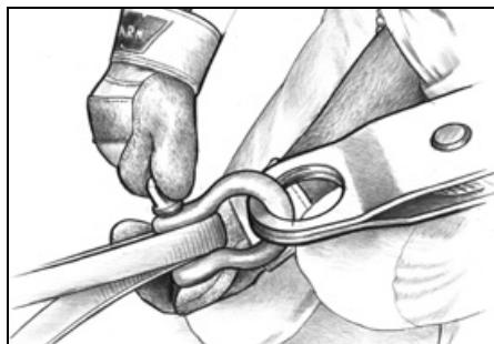
Закрепите крюк лебедки. При нахождении линии на грунте вставьте крюк лебедки в сергу. Проверьте закрепление. Перед продолжением работы убедитесь в надежности всех соединений и отсутствии мусора.
