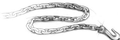
**Чокерная цепь** – Может быть использована для скрепления с другим автомобилем или с изогнутыми предметами в точке закрепления. Однако, следует учитывать, что цепи могут повредить или даже уничтожить деревья.
