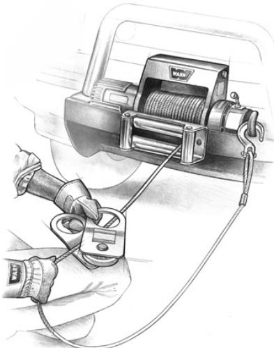
Выключите сцепление и с помощью такелажного блока вытяните секцию троса, длина которой достаточна для достижения вашей точки закрепления. Не крепите крюк к монтажному комплекту.
