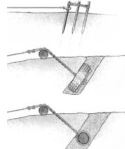
**Запасное колесо, закопанное на достаточную глубину, и цепь, закрепленная через обод.**
