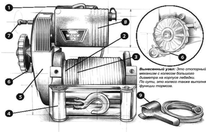
Конструкция лебедки 8274-50 отличается от представленной. В редукторе данной лебедки используется прямоугольная цилиндрическая зубчатая передача. Кроме того, на корпусе имеется автоматический дисковый тормоз.
