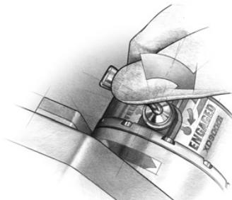
**Операция 7: ВКЛЮЧИТЬ СЦЕПЛЕНИЕ.** Введите в зацепление барабан лебедки путем поворота рычага сцепления на лебедке в положение Engage
