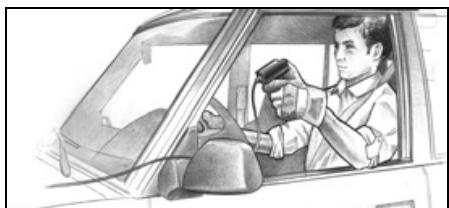
**Операция 14: ПРИСТУПИТЬ К РАБОТЕ.** При работающем двигателе автомобиля с лебедкой и наличии небольшого натяжения проволочного троса начинайте медленную и плавную буксировку. Контролируйте равномерность и плотность наматывания проволочного троса на барабан лебедки. Для оказания помощи лебедке можно медленно увеличивать обороты двигателя автомобиля.
