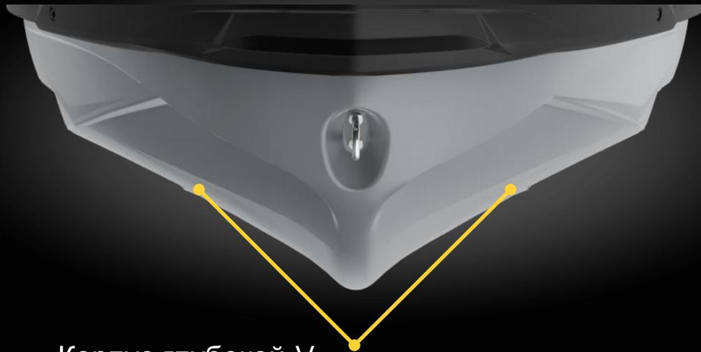
Корпус глубокой V-образной конструкции
