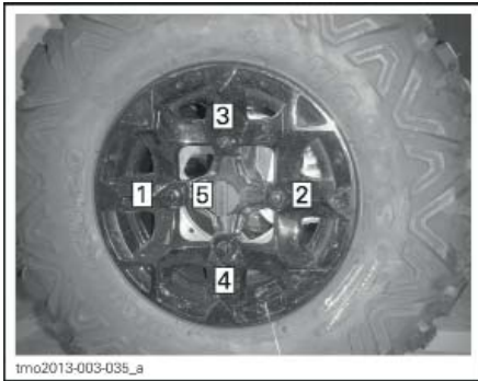
ПОСЛЕДОВАТЕЛЬНОСТЬ ЗАТЯЖКИ
