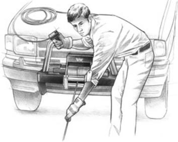
**Операция 9: СОЗДАТЬ НАТЯЖЕНИЕ ПРОВОЛОЧНОГО ТРОСА.** С помощью выключателя управления лебедкой медленно наматывайте трос до исчезновения его провисания. После создания натяжения проволочного троса не прикасайтесь к нему.
