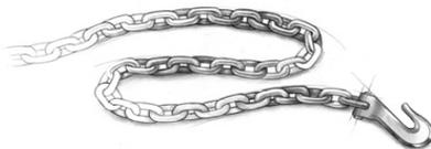
**Чокерная цепь** – Может быть использована для сцепления с другим автомобилем или с изогнутыми предметами в точке закрепления. Однако, следует учитывать, что цепи могут повредить или даже уничтожить деревья.
