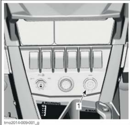
1. Электрическая розетка (12 В)
