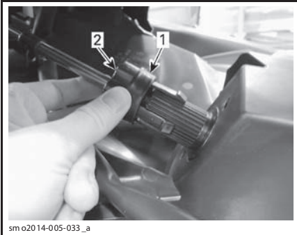
ОТСОЕДИНЕННЫЙ ТРОСОВЫЙ ПРИВОД
