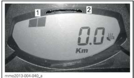
ОТОБРАЖЕНИЕ ИНТЕНСИВНОСТИ ПОДОГРЕВА 1. Интенсивность подогрева ниже 2. Интенсивность подогрева выше
