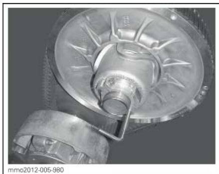
ПРИСПОСОБЛЕНИЕ ДЛЯ РАЗВЕДЕНИЯ ВЕДОМОГО ШКИВА УСТАНОВЛЕНО В РЕГУЛИРОВОЧНУЮ МУФТУ
